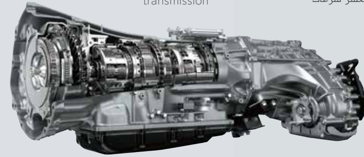
10-Speed automatic transmission ناقل حركة أوتوماتيكي بعشر سرعات
